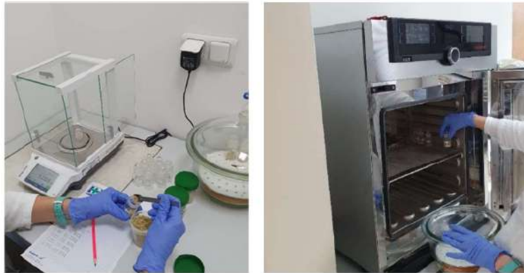
Slika 3.5. Priprema uzoraka za analizu suhe tvari (lijevo); Laboratorijska sušnica Model 30-1060, Memmert, Njemačka (desno)
