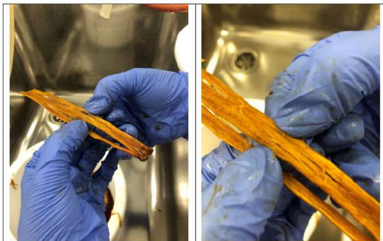
Slika 2.8. Stabljika miskantusa obrađena s 5% NaOH uz pomoć mikrovalova
