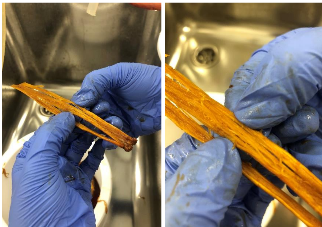
Slika 2.3.6. Stabljika miskantusa obrađena s 5% NaOH uz pomoć mikrovalova
