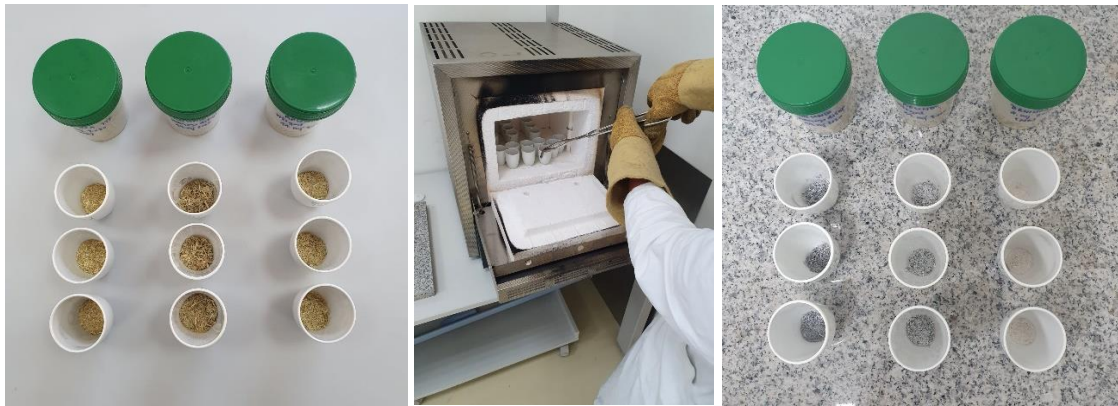
Slika 1.3.14. Određivanje sadržaja pepela; uzorci prije analize (lijevo), analize pepela u mufolnoj peći (sredina), uzorci nakon analize (desno)
