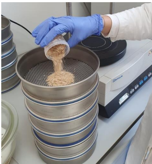
Slika 1.3.11. Sito tresilica (AS 200, Retsch GmbH, Njemačka)
