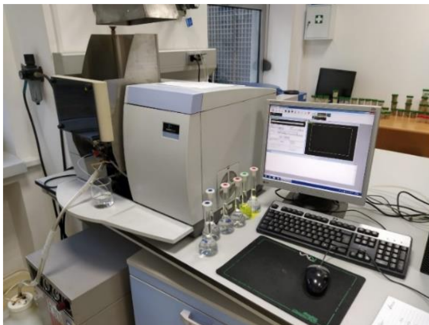
Slika 1.3.19. Analiza mikro i makro elemenata na AAS
