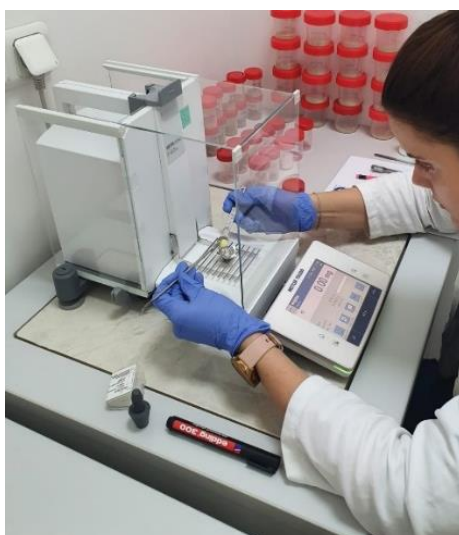
Slika 1.3.17. Priprema uzoraka za analizu CHNS
