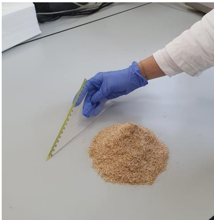
Slika 1.3.12. Uzorkovanje uzorka metodom četvrtanje
