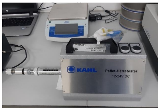
Slika 3.3.6. Uređaj za testiranje tvrdoće peleta u laboratoriju
