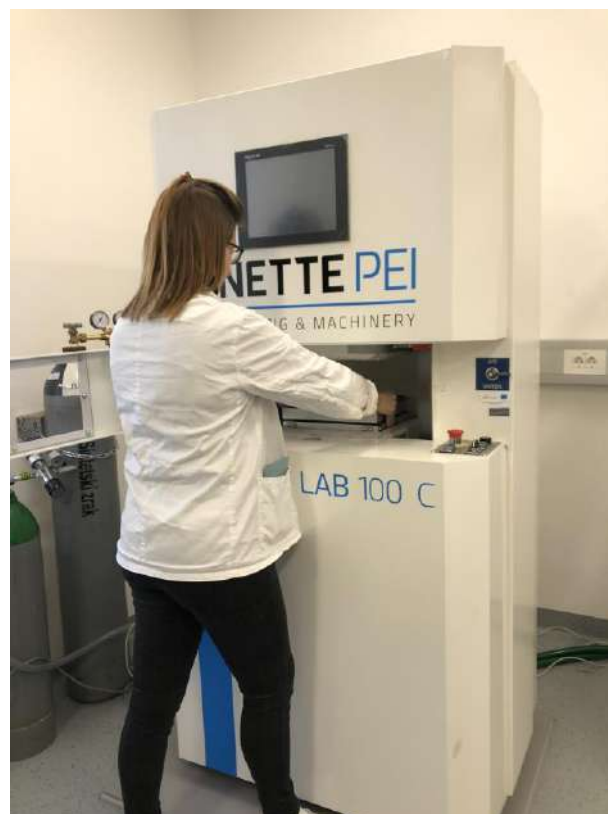
Slika 2.7.6. Vakuumska kompresijska preša
