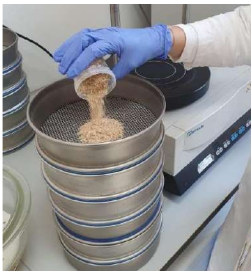
Slika 1.3.11. Sito tresilica (AS 200, Retsch GmbH, Njemačka)
