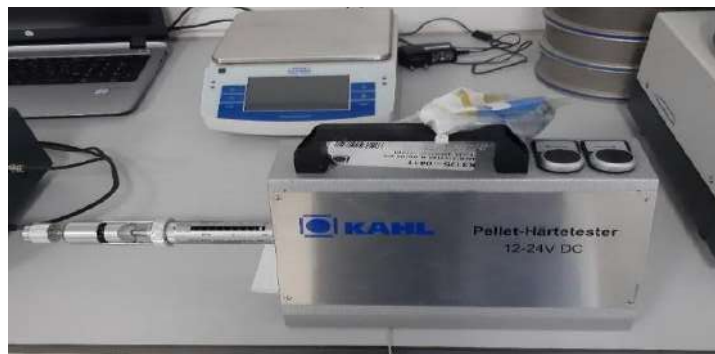
Slika 3.3.6. Uređaj za testiranje tvrdoće peleta u laboratoriju
