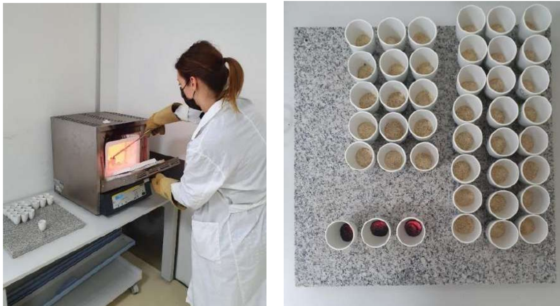
Slika 1.3.15. Analiza koksa (lijevo), uzorci prije i nakon analize (desno)
