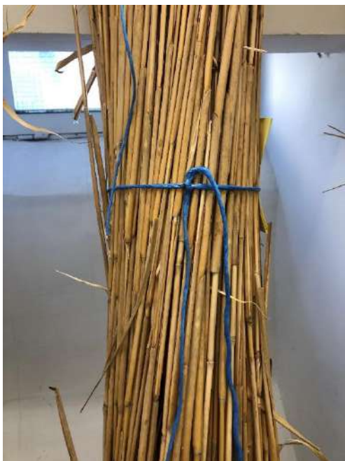
Slika 1.3.27. Snop miskantusa iz kojeg će se izolirati vlakna
