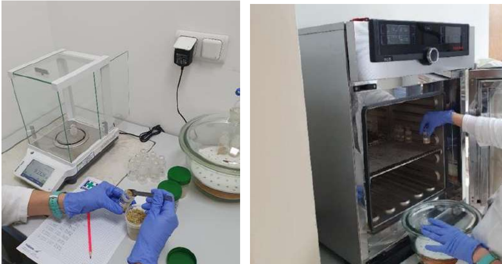
Slika 1.3.13. Priprema uzoraka za analizu suhe tvari (lijevo); Laboratorijska sušnica Model 30-1060, Memmert, Njemačka (desno)
