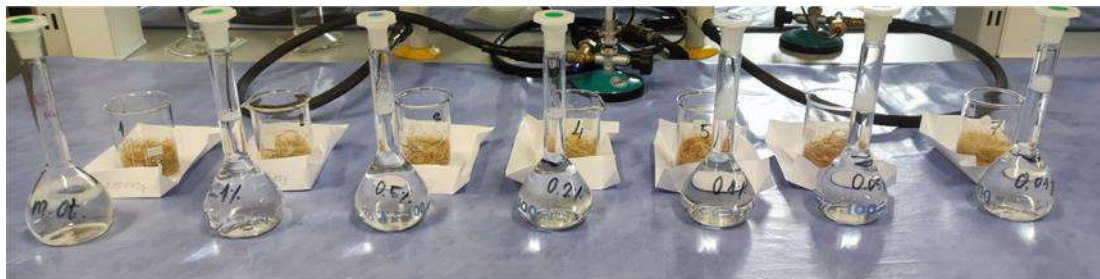
Slika 2.2.1. Izlaganje vlakana niskokonzentriranim otopinama enzima proteaza.
