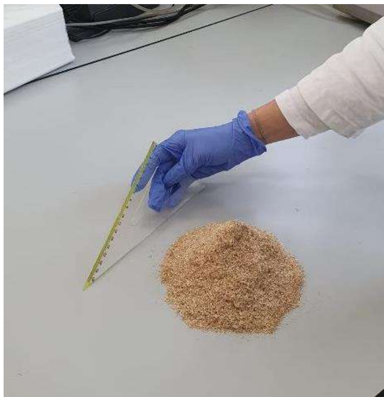
Slika 1.3.12. Uzorkovanje uzorka metodom četvrtanje
