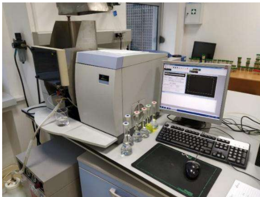
Slika 1.3.19. Analiza mikro i makro elemenata na AAS
