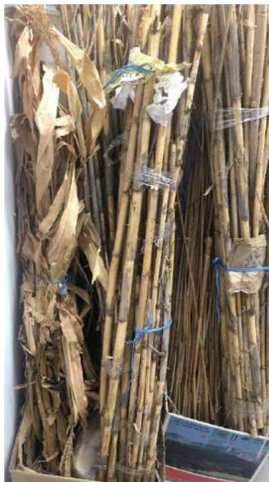
Slika 1.3.26. Snopovi Divovske trske iz kojih će se izolirati vlakna
