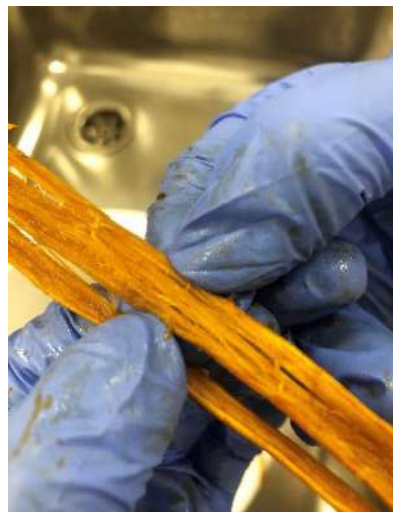
Slika 2.3.6. Stabljika miskantusa obrađena s 5 % NaOH uz pomoć mikrovalova
