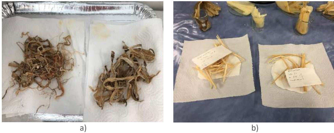
Slika 2.3.8. Ostatak stabljike miskantusa nakon obrada sa svrhom izolacije vlakana u a) 5 % NaOH i b) H 2 O 2 i limunska kiselina
