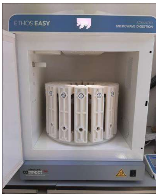
Slika 3.3.8. Uređaj za mikrovalnu digestiju (Mikrovalni sustav za zatvorenu digestiju)
