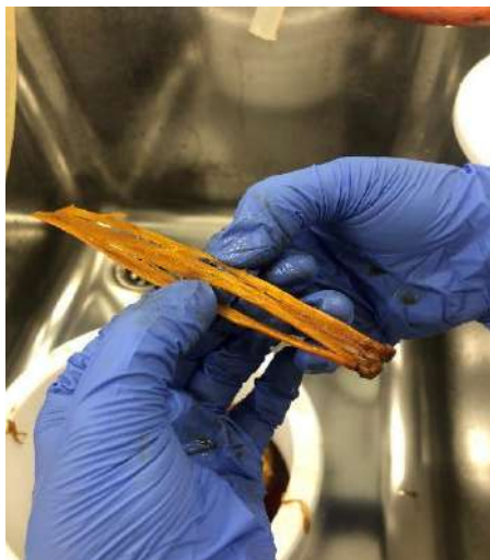
Slika 2.3.6. Stabljika miskantusa obrađena s 5 % NaOH uz pomoć mikrovalova
