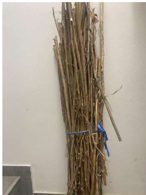
Slika 1.3.28. Snop Virdžinijskog sljeza iz kojeg će se izolirati vlakna
