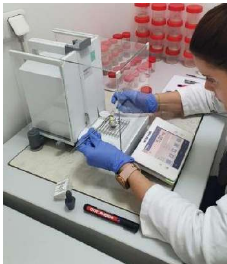
Slika 1.3.17. Priprema uzoraka za analizu CHNS
