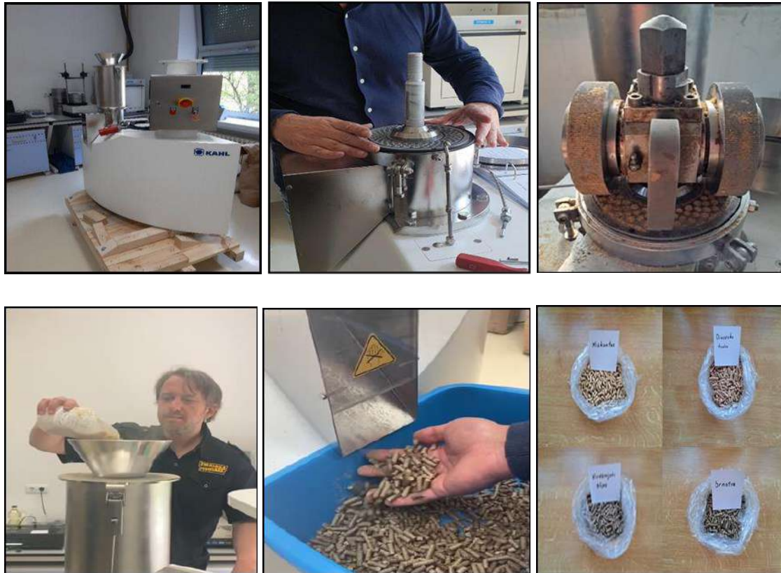
Slika 1.3.20. Postupak peletiranja i proizvedeni peleti
